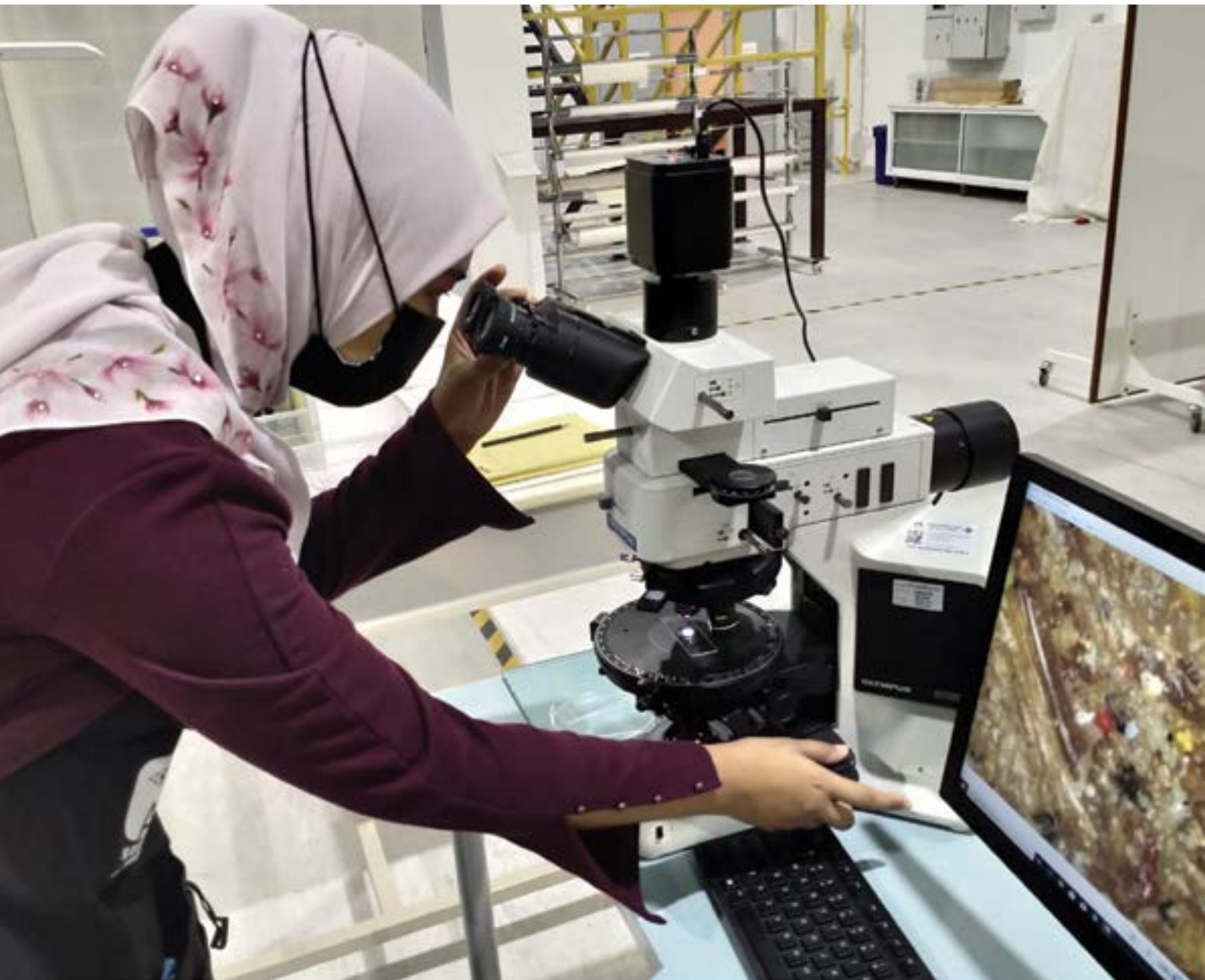
Pemerhatian dengan menggunakan peralatan Polarizing Microscope System BX53M pada lapisan cat karya atas kertas bagi tujuan melihat kandungan bahan pelukis.
