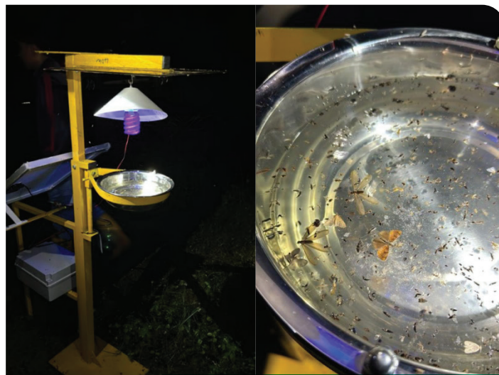
Rajah 8. Lampu UV dengan kekuatan 365 watt menunjukkan respon yang positif kepada tangkapan kupu-kupu jantan ulat bungkus.
