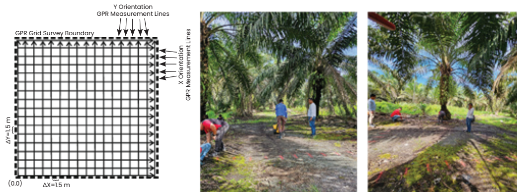
Rajah 6. Penyediaan scanning grid dan protokol untuk prosedur Ground Penetrating Radar (GPR).
