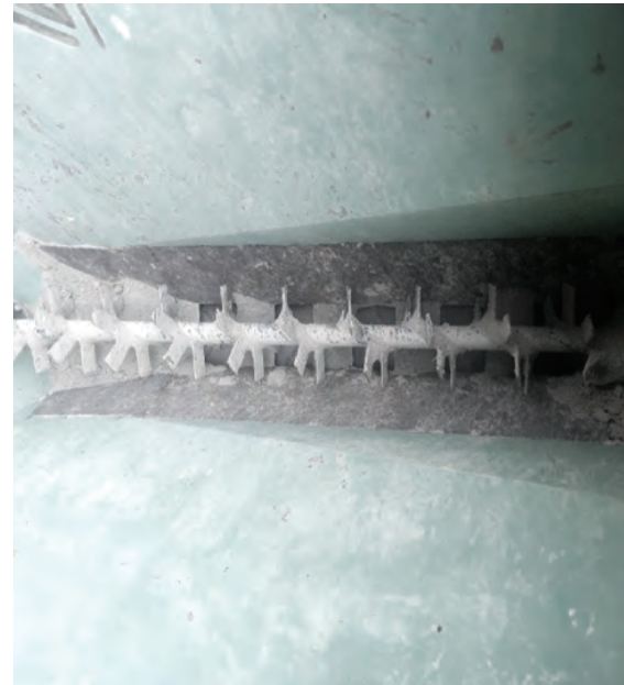
Rajah 2: Pengubahsuaian tangki dengan pemasangan plat gelongsor di sisi
