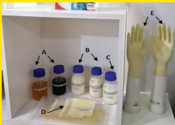
Rajah 2: Penstabil berasaskan sawit dan produk lateks getah asli yang dihasilkan, termasuk (A) Penstabil, (B) Lateks pekat ammonia rendah, (C) Lateks pekat bebas ammonia, (D) Filem latex dan (E) Sarung tangan celup
