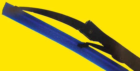
Rajah 1: Prototaip pengelap cermin depan kereta berinovasi dwibilah menggunakan teknologi pembuatan aditif
