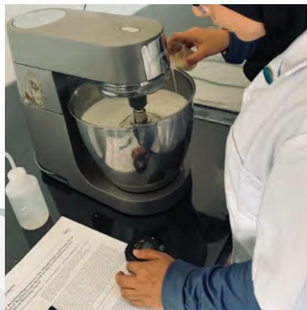
Rajah 5: Pekerja ASBK menunjukkan kemahiran menghasilkan tapak dalam busa lateks DPNR
