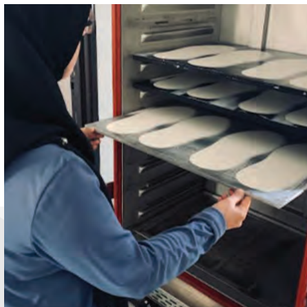
Rajah 5: Pekerja ASBK menunjukkan kemahiran menghasilkan tapak dalam busa lateks DPNR
