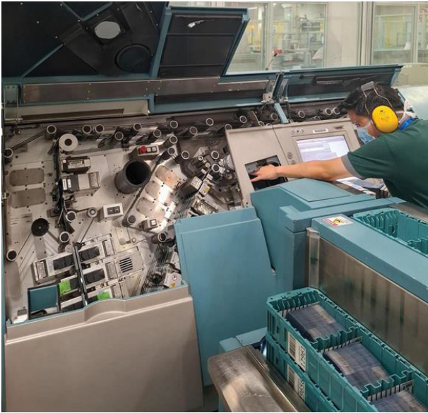
Wang kertas yang tidak lagi sesuai untuk edaran akan dikesan secara automatik menggunakan mesin pemprosesan berkelajuan tinggi dan dikeluarkan daripada edaran
