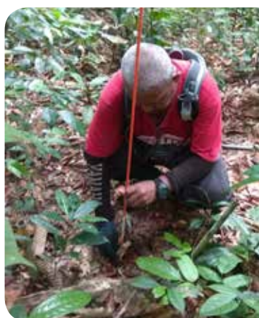
Pengukuran tanah untuk profil kandungan air tanah Ground measurement for profile soil water content
