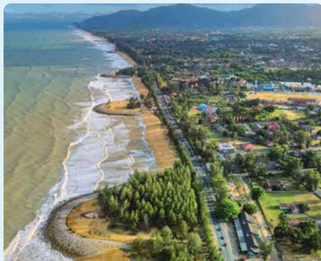
Pembinaan tanjung buatan dan “ beach nourishment ” di Pantai Teluk Lipat, Dungun, Terengganu
