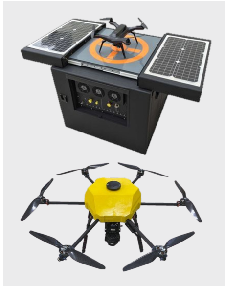
Rajah 65 Dron pintar bersama sistem stesen dok mudah alih
