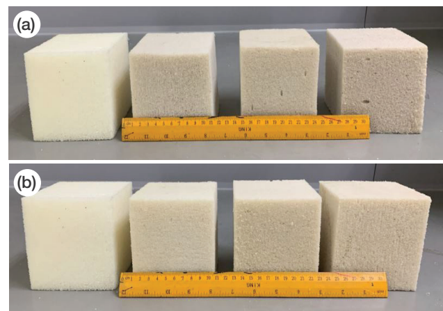
Rajah 1. (a) Komposit poliuretana fleksibel berasaskan sawit dengan gentian TBK, dan (b) gentian kenaf.
