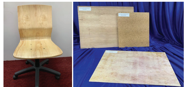
Rajah 2. Kerusi pejabat dan papan serpai yang dihasilkan menggunakan perekat poliuretana sawit.
