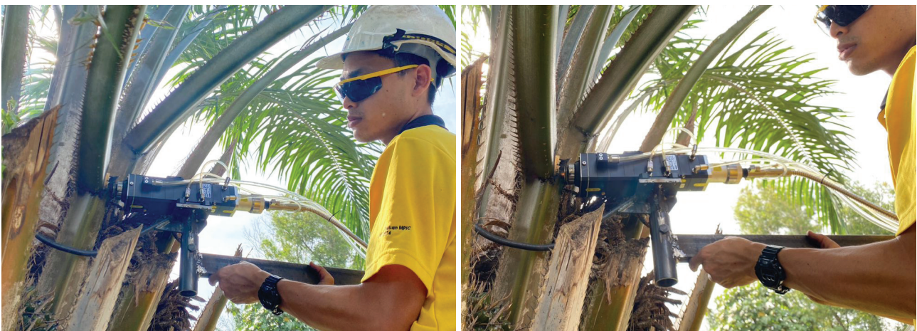
Rajah 1. Ujian penggunaan teknologi laser untuk pemotongan pelepah dan tandan.
